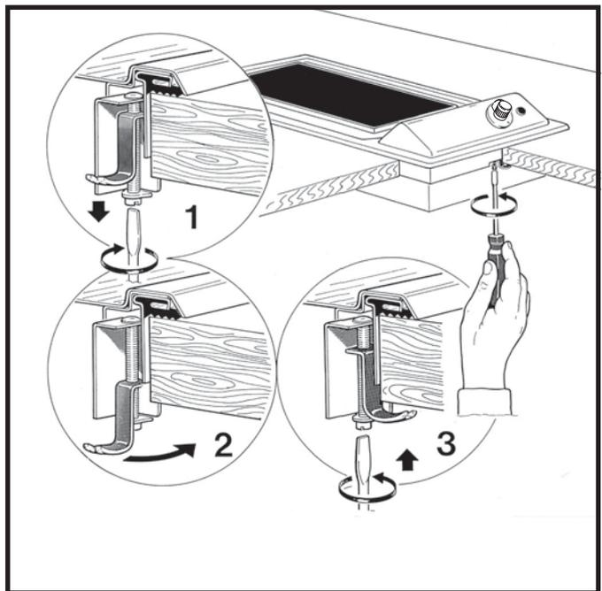
Das Grundmöbel bedarf keiner besonderen Herstellungsmerkmale, was die Isolierung und Entlüftung des Geräts betrifft. Wenn zwischen der unteren Seite des Kochflächengehäuses, und dem darunterliegenden Möbel eine Trennwand besteht, so ist zwischen den beiden Oberflächen ein Zwischenraum von 2 - 3 cm vorzusehen.
