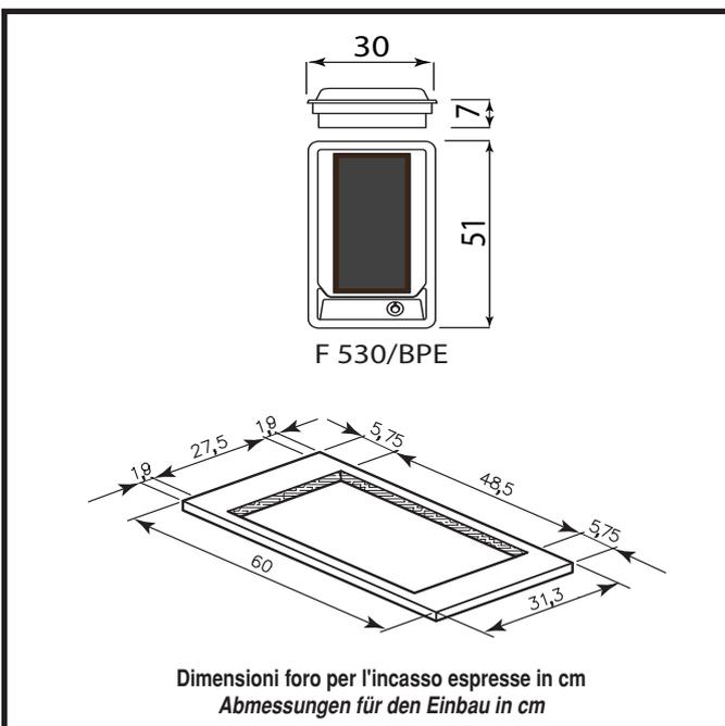
Il mobile base non necessita di alcun accorgimento costruttivo per l'isolamento o l'aerazione del solo piano cottura. Nel caso in cui tra la parte inferiore del cassone piano cottura ed il mobile sottostante ci fosse un piano divisorio, lasciare uno spazio fra le due superfici di circa 2 - 3 cm.
